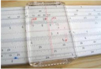
– Uma Régua de cálculo é um aparato mecânico-analógico que permite a realização de cálculos por meio de réguas graduadas deslizantes. Antes de aparecerem às calculadoras e os computadores pessoais, eram usadas para fazer operações matemáticas.
